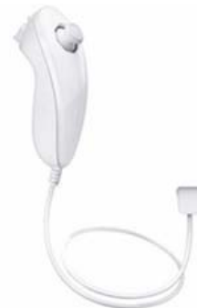
Wii Nunchuk: 3 axis accelerometer
